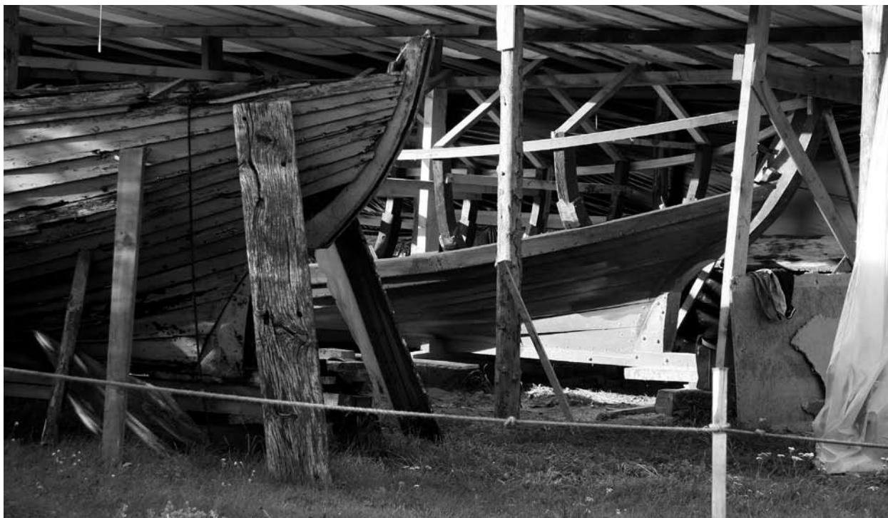
Kurėno „SŪD 1“ statyboje naudotos autentiškos medžiagos ir technologijos. A. Mažūno nuotrauka
